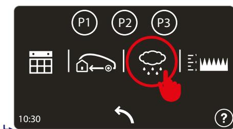
Imposta il comportamento del robot quando il sensore riconosce la pioggia.
