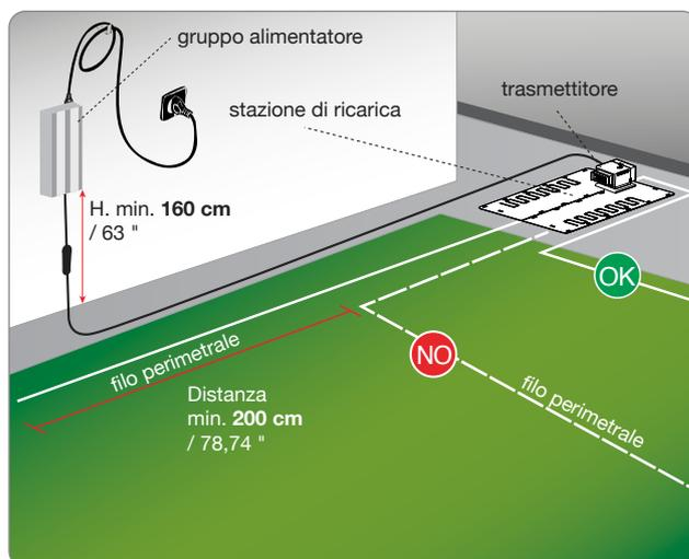
In caso di installazione del robot vicino ad un'area in cui è installato un altro robot (uguale o di un diverso produttore) si dovrà effettuare, in fase di installazione, una modifica al trasmettitore e ricevitore del robot in modo che le frequenze dei due robot non si disturbino a vicenda.
