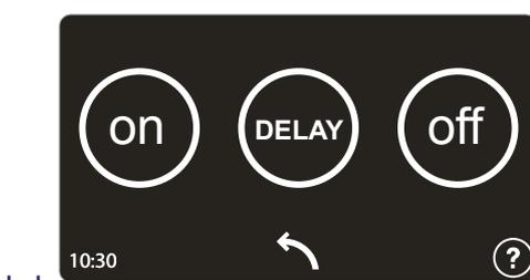
**ON:** al riconoscimento della pioggia il robot ritorna alla stazione di ricarica. Terminato il ciclo di ricarica il robot riprende il normale funzionamento in automatico, se il sensore non rileva la pioggia.
