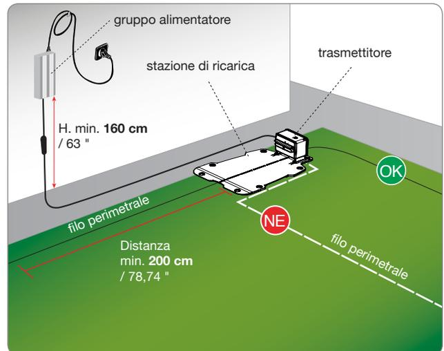
In caso di installazione del robot vicino ad un'area in cui è installato un altro robot (uguale o di un diverso produttore) si dovrà effettuare, in fase di installazione, una modifica al trasmettitore e ricevitore del robot in modo che le frequenze dei due robot non si disturbino a vicenda. In questo caso contattare il centro assistenza più vicino.
